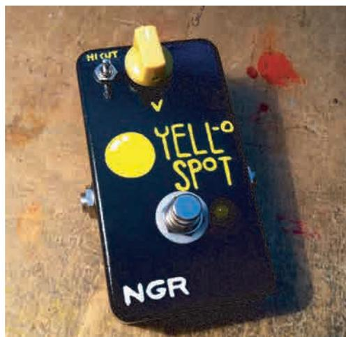
Lo Yell-o Spot è un clean booster basato su un singolo stadio di transistor BJT. Molto semplice nella sua struttura e nei controlli.
